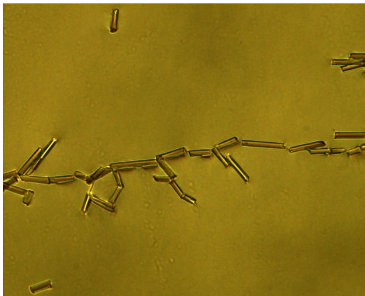
Рис.4.15. Фотографія захоплення циліндричних частинок в лінії дисклінації. Діаметр скляного циліндра становить 5 мікрометрів, а довжина 20 мікрометрів.
