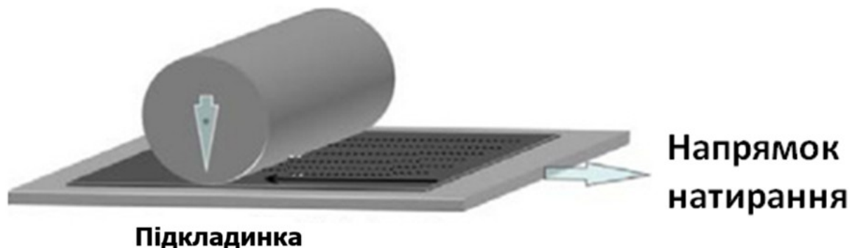
Рис.1.4 Нанесення орієнтації на підкладинці шляхом натирання
