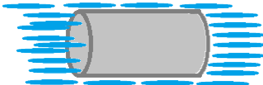
Рис 4.14. Схематичне зображення розподілу молекул рідинного кристалу навколо циліндричної частинки в нематичному рідинному кристалі
